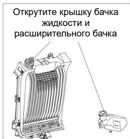
Рис. 41 Добавление охлаждающей жидкости
