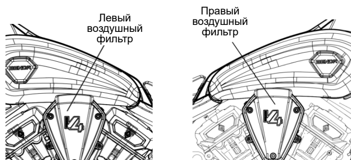
Рис. 25 Расположение воздушных фильтров
