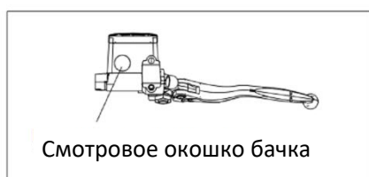
Рис. 33 Проверка уровня тормозной жидкости переднего тормоза в бачке
